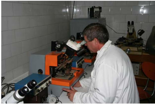
Controlul optic final al sudurilor conexiunilor firelor de aur de 25 microni
